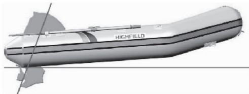
Proa arriba, demasiada inclinación hacia atrás
